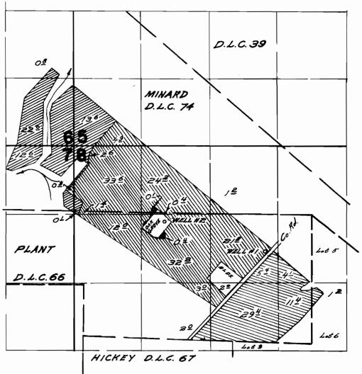
WELL NI LOCATED 26 Ch. N. & 10 Ch. E.; WELL NZ LOCATED 2320 FL.N. & 13 10 FL.W. BOTH FROM NE. CORNER HICKEY DLC 67
