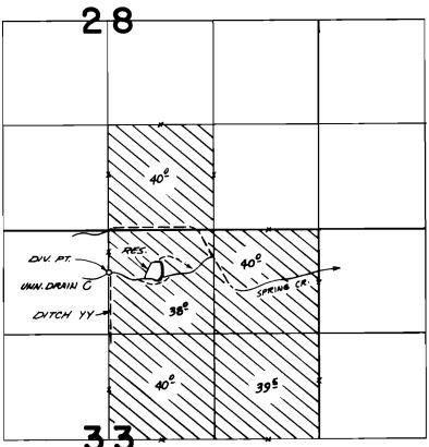
DIV. PT. LOCATED 540'S. \$ 5'E.; COLLECTION DITCH YY LOCATED BETWEEN POINTS 540'S. \$ 5'E \$ 1450'S. \$ 5'E. RES. LOCATED GOO'S. \$ 680'E. ALL FROM THE N. YA COR. SEC. 33.
