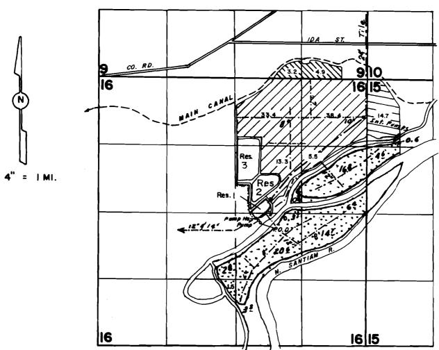
P. O.D. : RESERVOIR - 120'S. & 420'E.; STREAM - 190'S. & 500'E. FROM CENTER OF SEC. 16.
