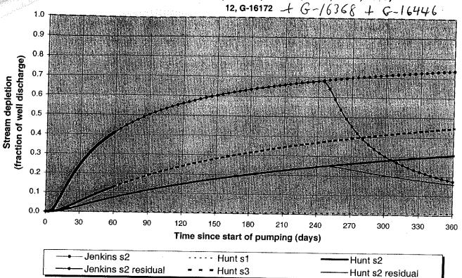
Output for Hunt Stream Depletion, Scenerio 2 (s2): Time pump on = 240 days Days 30 -160 120 150 180 210 240 270 300 330 360 Hunt SD s2 0.030 0.076 0.115 0.149 0.177 0.203 0.225 0.245 0.234 0.204 0.180 0.161 Qw, cfs -1,000 1.000 1.000 1.000 1.000 1.000 1.000 1.000 1.000 1.000 1.000 1:000 H SD s2, cfs 0.030 0.225 0.204
